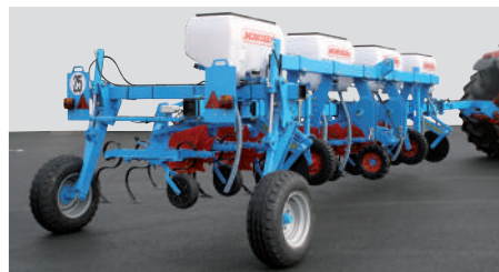
Bineuse rigide TIP 5 pouces 8 rangs à 70 cm d'inter-rang au transport
