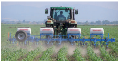
Bineuse rigide TIP 5 pouces 8 rangs à 70 cm d'inter-rang au travail
